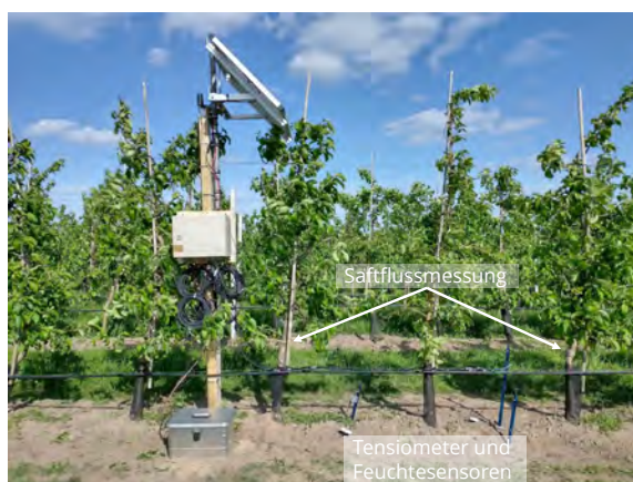
Abbildung 3.23.: Boden- und Saftfluss-Messsystem
